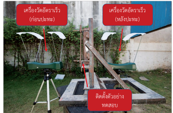
รูปที่ 4 การติดตั้งเครื่องวัดอัตราเร็วกระสุน
