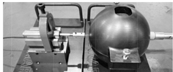
รูปที่ 7 ชุดอุปกรณ์วัดการหดและขยายตัวของผู้วิจัย
