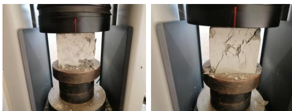
รูปที่ 6 การทดสอบกำลังอัดของคอนกรีต
