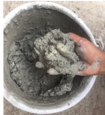
รูปที่ 4 การจับตัวเป็นก้อนของคอนกรีตผสมน้ำยางพาราในปริมาณเกินร้อยละ 30
