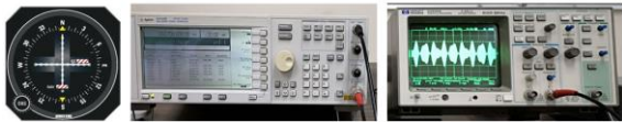
รูปที่ 13 ชุดทดลองการส่งสัญญาณระบบโกลด์สโปล
