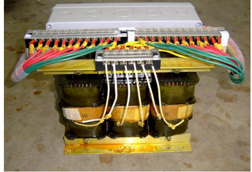
รูปที่ 5: หม้อแปลงแบบออตโตสำหรับระบบเรียงกระแสแบบ 18 พัลส์ ที่สร้างขึ้น
