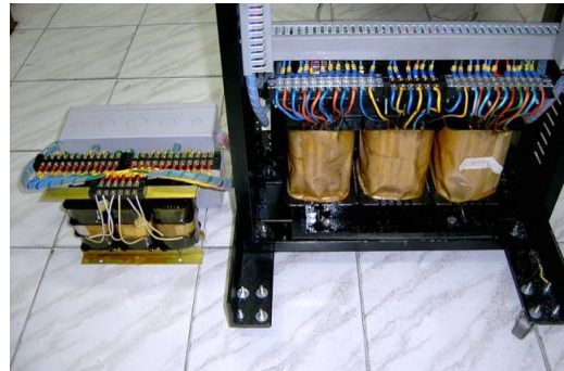
รูปที่ 6: เปรียบเทียบหม้อแปลงสำหรับระบบเรียงกระแสแบบ 18 พัลส์ที่อัตรากำลังเท่ากันโดยด้านซ้ายเป็นหม้อแปลงแบบออตโตและด้านขวาเป็นแบบชิกแซ็ก
