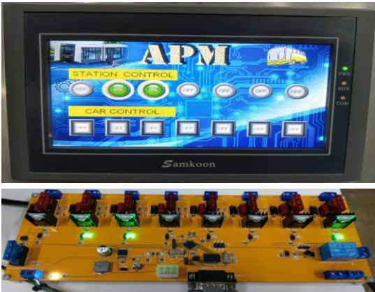
รูปที่ 24 ผลทดสอบการควบคุมเอพีเอ็มด้วยสถานี
