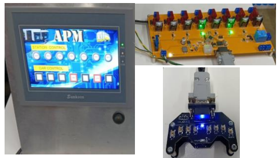
รูปที่ 23 ผลทดสอบการควบคุม เอพีเอ็ม ด้วยตัวรถ
