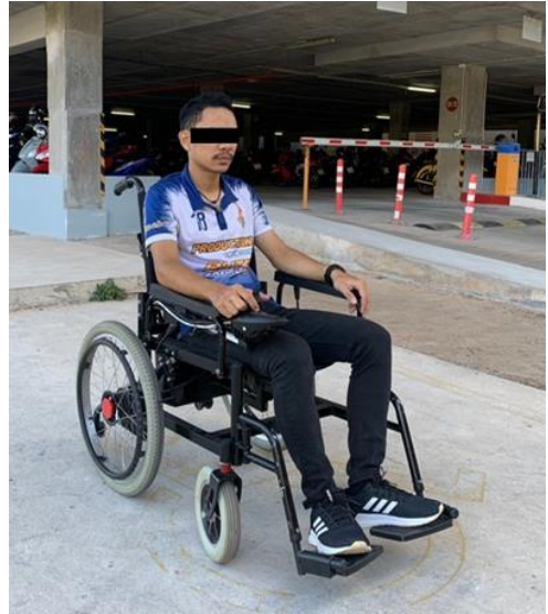
รูปที่ 5 การทดสอบระยะหยุดนิ่งของรถเข็นไฟฟ้าสำหรับผู้สูงอายุ
