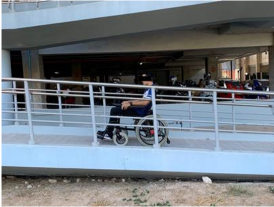
รูปที่ 7 การทดสอบการวิ่งบนทางลาดชันของรถเข็นไฟฟ้าสำหรับผู้สูงอายุ
