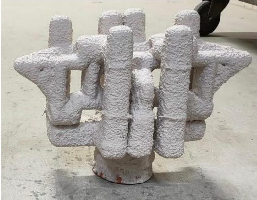
รูปที่ 3 ชิ้นงานหลังการเคลือบวัสดุทนไฟ เพื่อเป็นแม่พิมพ์หล่อ
