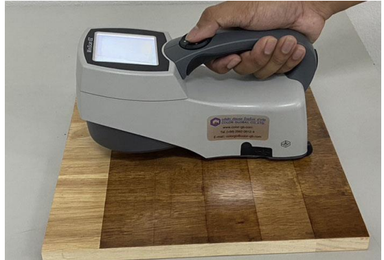
รูปที่ 7 การวัดค่าสีบนชิ้นไม้ยางพาราประสานย้อมสี
