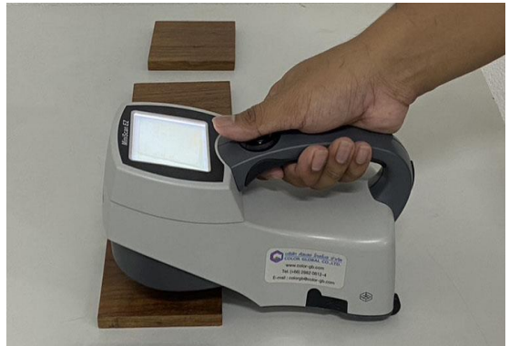
รูปที่ 8 การวัดค่าสีบนชิ้นไม้สักตัวอย่าง
