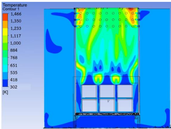
รูปที่ 8 ผลการจำลองอุณหภูมิในห้องเผาไหม้
