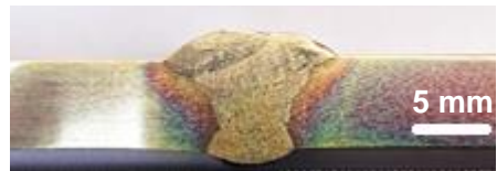
รูปที่ 11 โครงสร้างมหภาคของชิ้นงานเชื่อมด้วยโลหะเติม AWS A5.9 ER2209
