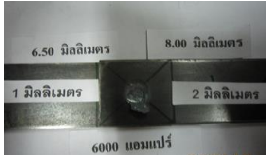
รูปที่ 5 ชิ้นงานเชื่อมด้วยกระแสไฟฟ้า 6000 แอมแปร์
