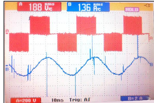
รูปที่ 8 แสดงสัญญาณ PWM และ กระแส ไซนูซอยด์ที่ได้จากการวัด ที่ f_m เท่ากับ 25Hz และ f_s เท่ากับ 8kHz
