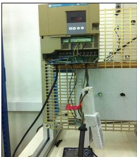
รูปที่ 4 แสดงการวัดกระแสด้วย Current Probes
