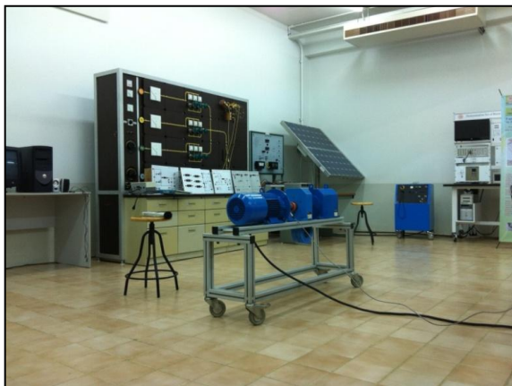
รูปที่ 2 แสดงการวัดระดับเสียง โดย Sound Level Meter ตามตำแหน่ง
