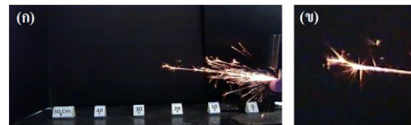
รูปที่ 15 (ก) ประกายไฟเหล็กกล้า SK 4 จากภาพถ่ายด้วยกล้องเว็บแคม (ข) การแตกของประกายแบบเดนไดรต์ (เหล็กกล้าคาร์บอนสูง)
