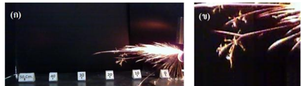
รูปที่ 21 (ก) ประกายไฟเหล็กกล้า SKD 11 จากภาพถ่ายด้วยกล้องเว็บแคม (ข) ลักษณะประกายไฟรูปดอกไม้ (เกิดจากโครเมียม)
