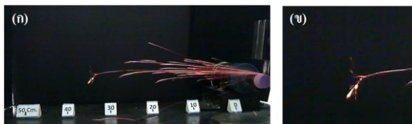
รูปที่ 19 (ก) ประกายไฟเหล็กกล้า SKH 51 จากภาพถ่ายด้วยกล้องเว็บแคม (ข) ลักษณะเส้นลำแสงเป็นแบบหางจิ้งจอก (เกิดจากทั้งสแตน)
