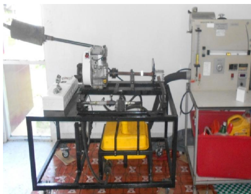
รูปที่ 4 เครื่องยนต์ต่อกับเครื่องวัดไดนาโมมิเตอร์อุทก-สถิต
