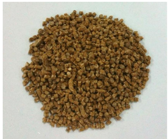
รูปที่ 5 เม็ดวัสดุเชิงประกอบพอลิโพรพิลีนและผงไม้ยางพารา
