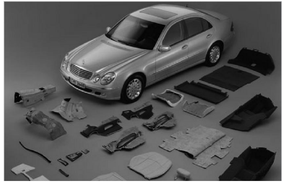
รูปที่ 2 วัสดุเชิงประกอบเส้นใยปอ ป่าน และป่าน สรณารายณ์ ถูกใช้ผลิตชิ้นส่วนรถยนต์ MercedesBenz รุ่น E-Class [38, 19]
