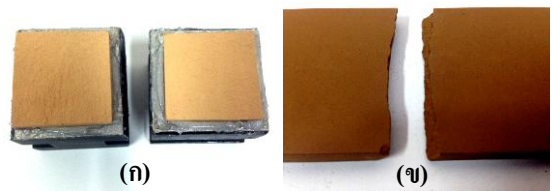
รูปที่ 6 การเสียหายของชิ้นงานทดสอบหลังการทดสอบ (ก) ความแข็งแรงดัดตั้งฉากกับผิวหน้า และ (ข) ความแข็งแรงดัด
