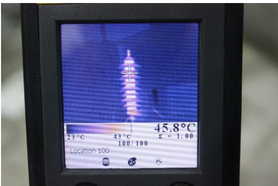
รูปที่ 7 ภาพถ่ายความร้อนของกับดักเสิร์จทดสอบที่ระดับแรงดัน 25 kVpeak
