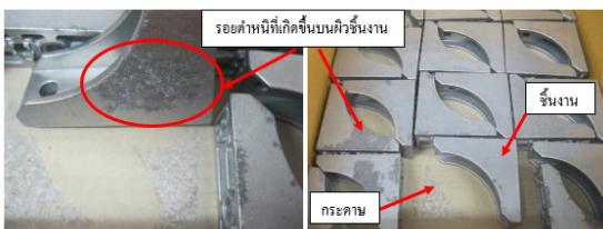
รูปที่ 2 ลักษณะตำหนิบนผิวชิ้นงาน
