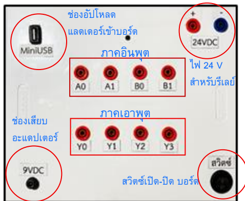
(a) Panel สำหรับต่ออุปกรณ์ภาคอินพุตและเอาพุต
