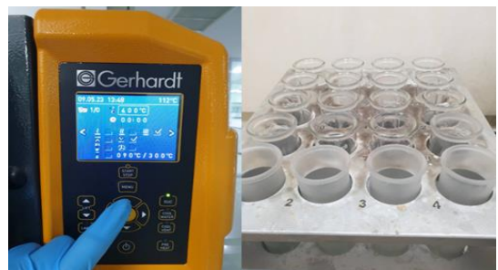
รูปที่ 10 ปรับตั้งค่าปัจจัยและระดับปัจจัยที่เหมาะสมของเครื่องย่อยไนโตรเจน
