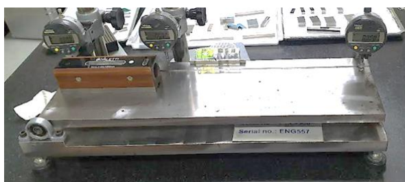
รูปที่ 2 เครื่องมือสอบเทียบฯ Level Tester ที่ CIB-BUU ใช้งานในปัจจุบัน
