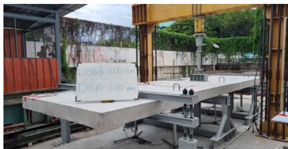
รูปที่ 6 การทดสอบกำลังรับแรงในห้องปฏิบัติการ
