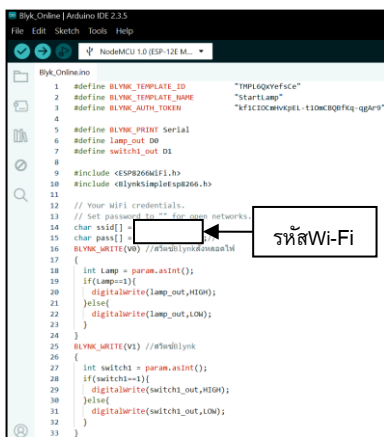
(a) การเขียนโค้ดสำหรับ อัปโหลดลงบอร์ดESP8266
