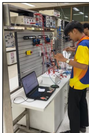
(b) การทดลองใช้ชุดฝึกต่อกับ อุปกรณ์นิวแมติกส์
