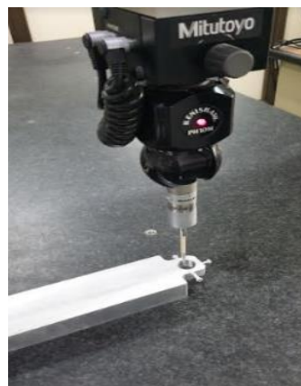
รูปที่ 12 การวัด Precision Bar ด้วยเครื่อง CMM
