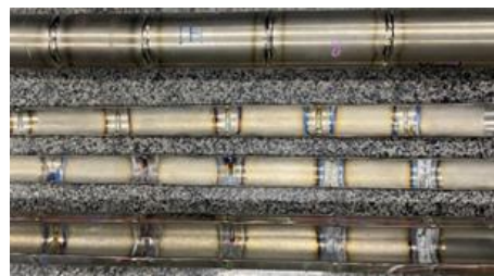
รูปที่ 6 ท่อไทเทเนียมที่ผ่านการตัดตามยาวเพื่อตรวจพินิจโดยตรงภายในท่อ
