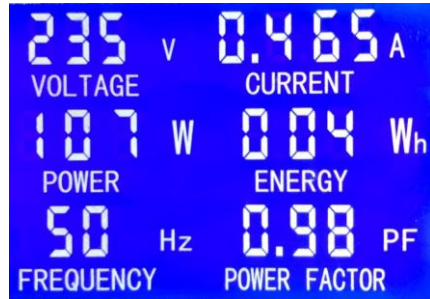
รูปที่ 21 ปริมาณทางไฟฟ้าในโหมตอินเวอร์เตอร์ เชื่อมต่อบระบบโครงข่ายไฟฟ้า
