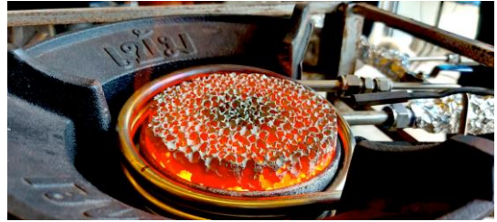
รูปที่ 1 ท่อระเหยเอทานอลที่รับความร้อนจากเตาวัสดุพอร์ซันแผ่รังสี
