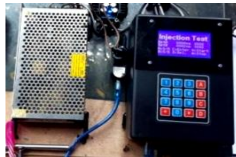
รูปที่ 7 ชุดควบคุมการฉีดเชื้อเพลิง
