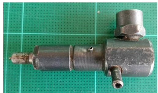
รูปที่ 2 หัวฉีดเชื้อเพลิงเดิมของเครื่องยนต์
