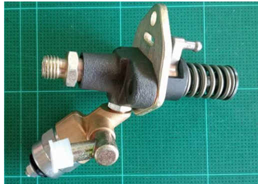
รูปที่ 1 ปั้มเชื้อเพลิงเดิมของเครื่องยนต์
