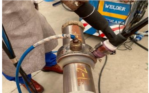
รูปที่ 3 การเชื่อมแบบใช้มือ (Manual) ที่หัวเชื่อมต้องทำการติดตั้งอุปกรณ์ปกคลุมแก๊ส (Trailer Shielding)
