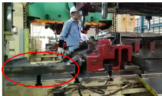
รูปที่ 8 ถาดขนาดใหญ่สำหรับรองรับเศษชิ้นงาน
