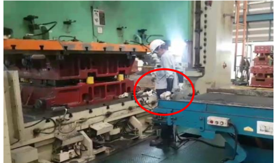
รูปที่ 6 ตำแหน่งของปั๊มแฮนด์สวิตช์ก่อนปรับปรุง
