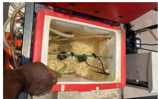
รูปที่ 5 ถังเก็บความร้อนภายในติดตั้งฮีตเตอร์ไฟฟ้าและเทอร์โมคัปเปิลชนิด K
