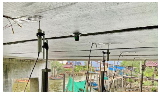
รูปที่ 4 การติดตั้งอุปกรณ์ตรวจวัดสะพานได้แผ่นดินสะพาน
