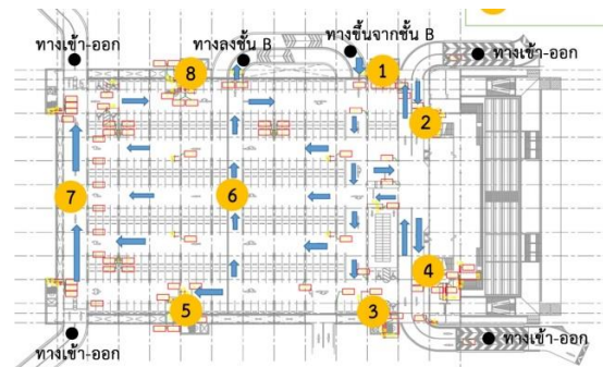
รูปที่ 2 แผนผังทิศทางเดินรถของลานจอดรถชั้นใต้ดิน A และจุดตรวจวัดปริมาณฝุ่นละอองขนาดเล็ก
