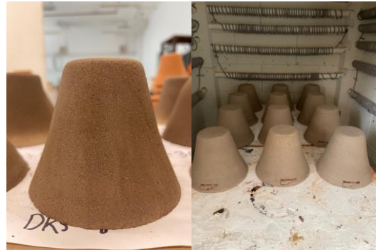
รูปที่ 2 ชิ้นงานฟิลเตอร์เซรามิกส์จากดินดานเกวียนรูปทรงเขาค้อนตาหลังปล่อยให้แห้งในอุณหภูมิห้องและนำเข้าเผาในเตาไฟฟ้า
