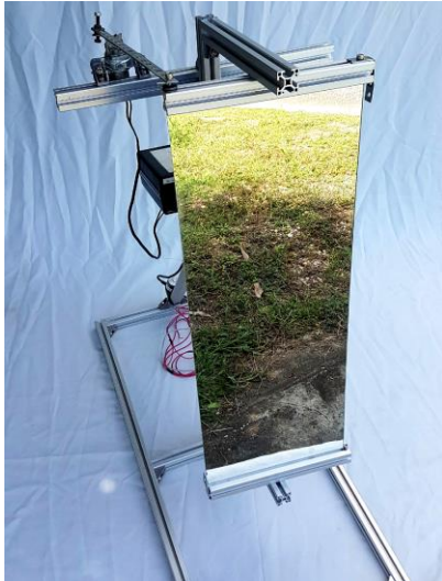
รูปที่ 4 โครงสร้างของระบบชดเชยแสงใต้เซลล์แสงอาทิตย์
