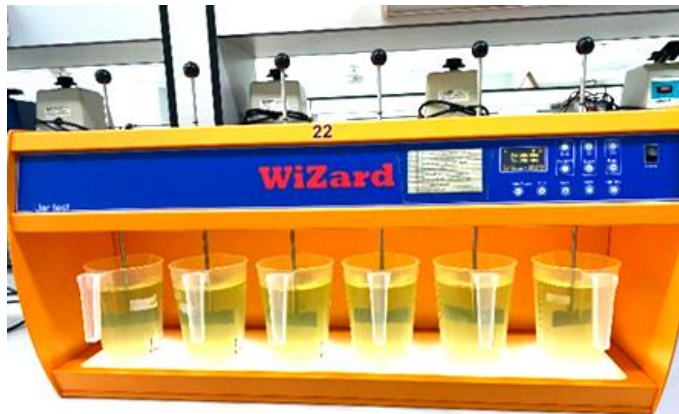
รูปที่ 2 การทดลองด้วยเครื่องทดสอบการตกตะกอนแบบ 6 ใบกวน
