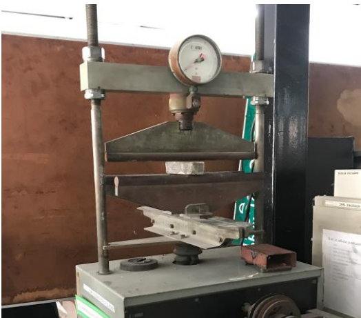
รูปที่ 5 การทดสอบกำลังอัดของมอร์ตาร์
