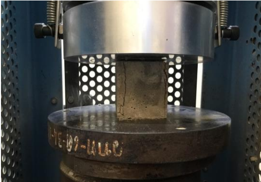
รูปที่ 4 การทดสอบกำลังอัดของมอร์ตาร์
