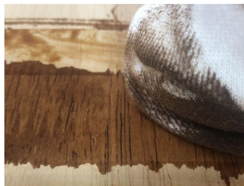
รูปที่ 5 เช็ดสีย้อมด้วยผ้าสะอาด
