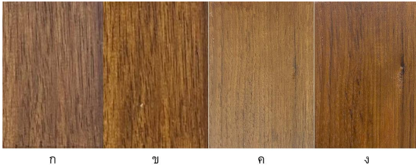
รูปที่ 14 เปรียบเทียบสีของไม้ยางพาราประสานย้อมสีกับไม้สัก
