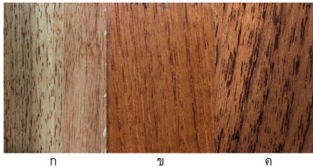
รูปที่ 15 เปรียบเทียบสีย้อมทั่วไปกับไม้ยางพาราและไม้สัก
