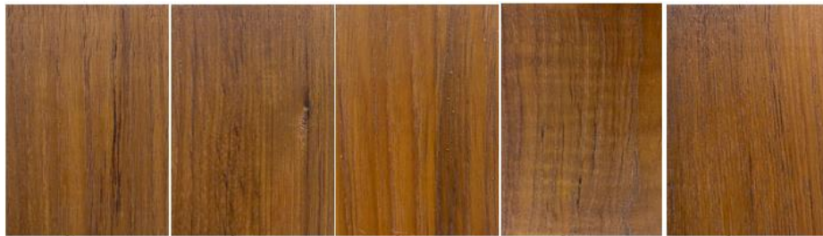
รูปที่ 10 สีชั้นไม้สักตัวอย่างที่พ่นเคลือบด้วยแลคเกอร์
