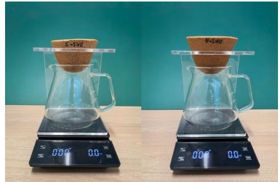
รูปที่ 3 ทดสอบหาการไหลตัวของน้ำร้อนผ่านฟิลเตอร์เซรามิกส์จากดินด่านเกวียน
