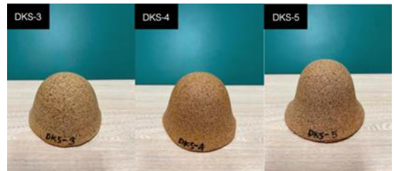
รูปที่ 9 ชิ้นงานทดสอบจากอัตราส่วนผสมที่ DKS-3 ถึง DKS-5 ขึ้นรูปด้วยวิธีการ Jigger
