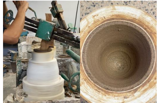
รูปที่ 1 การขึ้นรูปชิ้นงานฟิลเตอร์เซรามิกส์ด้วยเทคนิคการขึ้นรูปแบบ Jigger
