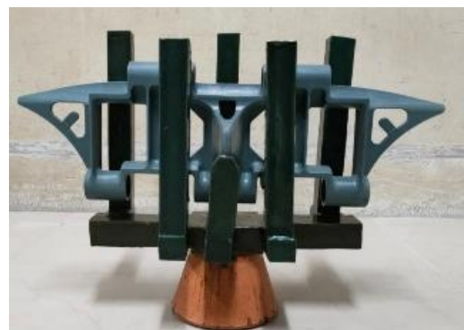
รูปที่ 2 ชิ้นงานหลังการประกอบเข้ากับส่วนต่างๆ ของระบบเทหล่อเป็นต้นเทียน (Way Tree)
