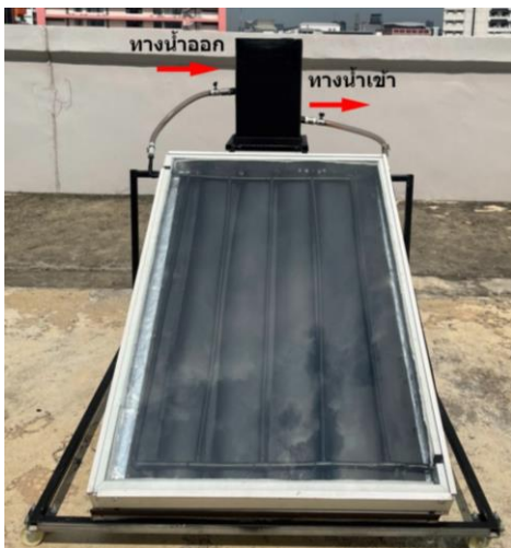
รูปที่ 7 อุปกรณ์ทำน้ำร้อนพลังงานแสงอาทิตย์ชนิดแผ่นเรียบ
