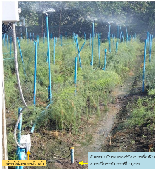
รูปที่ 9 การวัดความชื้นของหัวโพรบตัวรับรู้และการจ่ายน้ำของสปริงเกอร์ตลอดแนวจำนวน 6 หัวจ่าย
