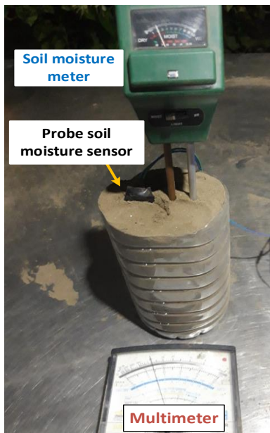
รูปที่ 6 การทดสอบหาความสัมพันธ์ของดินเทียบกับแรงดันไฟฟ้าขาออก
