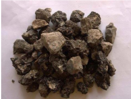
รูปที่ 1 แอสฟัลต์คอนกรีตเก่า
