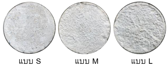
รูปที่ 4 พื้นผิวคอนกรีตเดิมที่มีความหยาบต่างกัน
