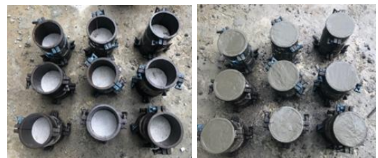
รูปที่ 6 การหล่อคอนกรีตใหม่บนคอนกรีตเดิม
