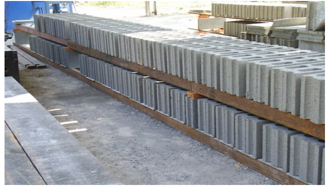
รูปที่ 3 การบ่มคอนกรีตบล็อกในลานโล่ง
