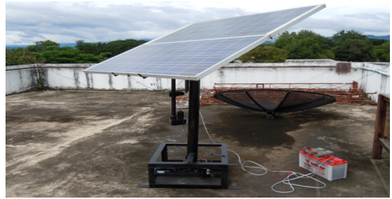
รูปที่ 11 โครงสร้างระบบติดตามดวงอาทิตย์ที่สมบูรณ์
