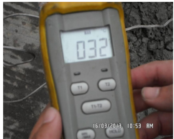
รูปที่ 8 การวัดอุณหภูมิของคอนกรีตสดก่อนเทคอนกรีต
