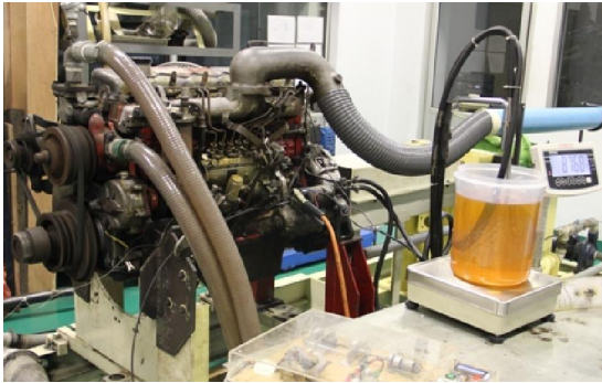
รูปที่ 1 เครื่องยนต์ HINO HO7C บนเครื่องทดสอบ
