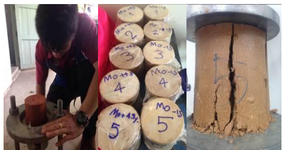
รูปที่ 3 ก้อนตัวอย่างที่ใช้ในการทดสอบกำลังรับน้ำหนัก
