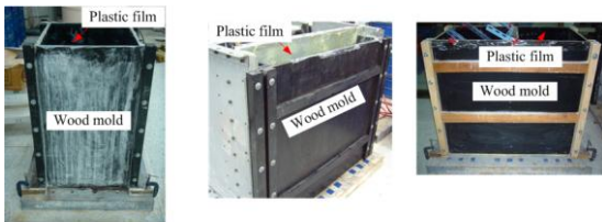
ก) 1/4แคปซูล ข) อุโมงค์แนวราบ ค) ครึ่งแคปซูล รูปที่ 3 แบบไม้ในการเตรียมตัวอย่าง
