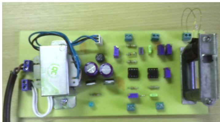
รูปที่ 2 เครื่องวัดกระแสไฟฟ้ารั่วที่สร้างขึ้น
