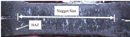
รูปที่ 7 โครงสร้างมหภาคบริเวณนั้กเกิด (Nugget Size) และเขตอิทธิพลความร้อน (Heat Affected Zone, HAZ)
