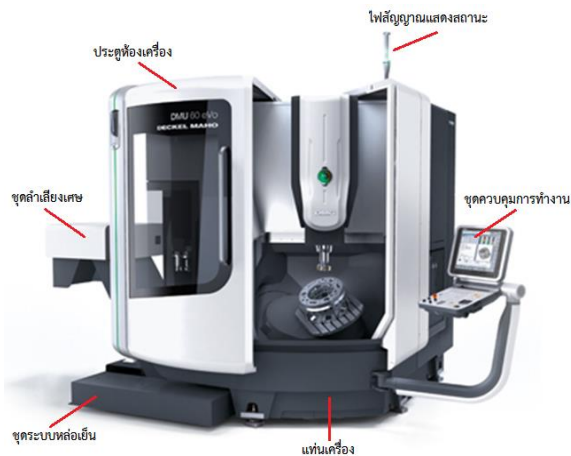
ภาพที่ 2 โครงสร้างภายนอกเครื่องกัด CNC 5 แกน
